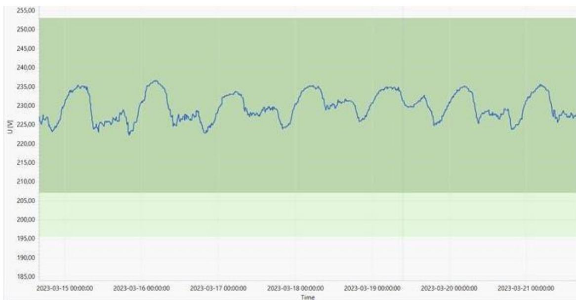
Slika 3: Grafički prikaz napona faze L1 nakon priključenja elektrane
