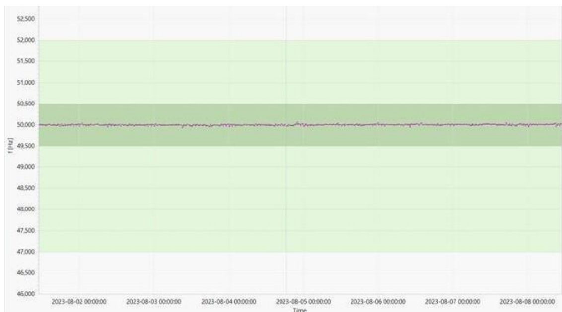
Slika 10: Grafički prikaz frekvencije nakon priključenja FNE
