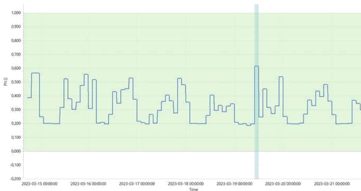
Slika 4: Grafički prikaz flikera faze L1 nakon priključenja elektran
