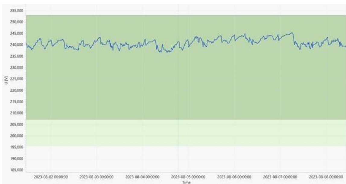
Slika 11: Grafički prikaz napona faze L1 nakon priključenja elektrane
